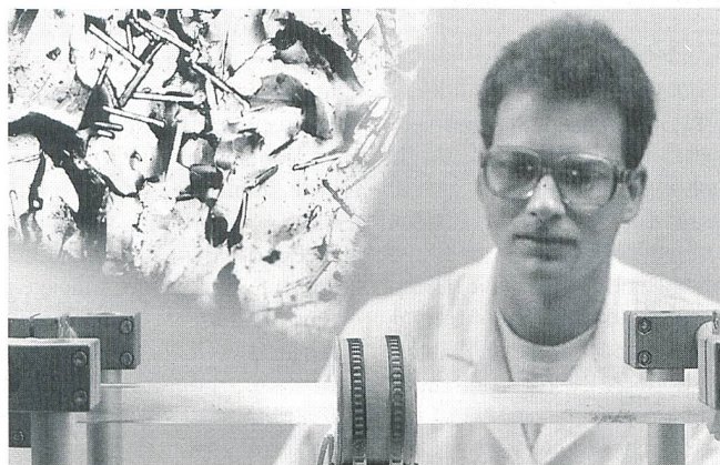
Schmelzprozess zur Herstellung eines Wismut-Kupfer-Supraleiters und mikroskopische Abbildung des Korngefüges des Werkstoffs
