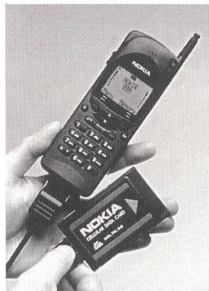
Datenfernübertragung mittels PCMCIA-Karte und Handy
