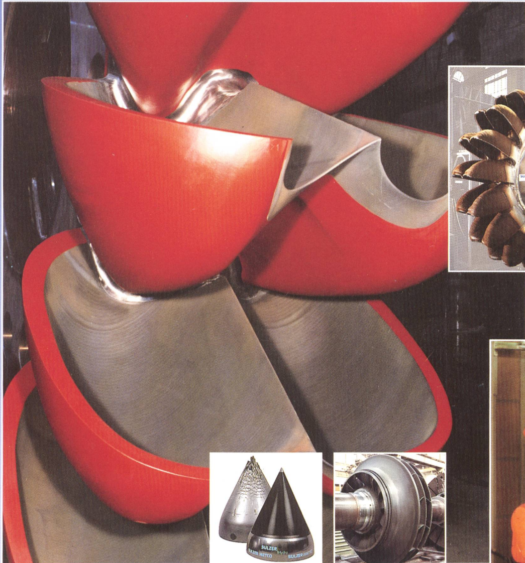
Beispiele für keramikbeschichtete Bauteile aus hydraulischen Maschinen
