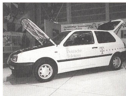
Bild 4 Vom bereits bekannten VW CityStromer wurden bereits über 100 Exemplare verkauft. Dank thermischer Stabilisierung kann VW auf die Bleibatterie drei Jahre Garantie geben.
