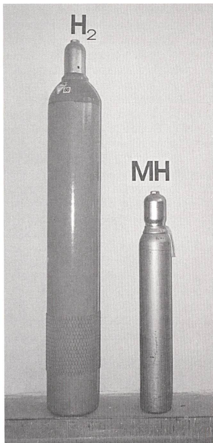
Bild 5 Volumeneffizienz der Wasserstoffspeicherung in Metallhydriden, verglichen mit jener in Druckflaschen
