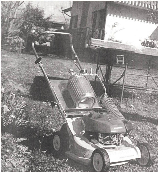
Bild 7 Wasserstoffbetriebener Rasenmäher mit aufmontiertem zylindrischem Metallhydrid-Wasserstoffspeicher
