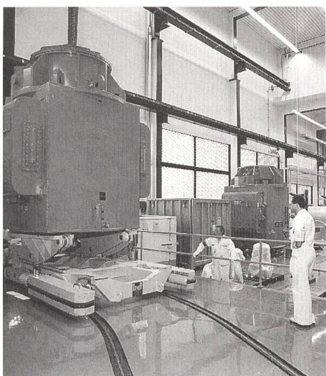
In der Aktivwerkstatt des KKL werden kontaminierte Anlagenteile untersucht und revidiert.
