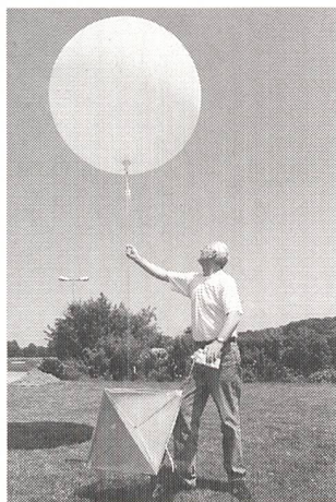
Wetterballon beim Start; sein Durchmesser vergrössert sich in 30 000 bis 40 000 Metern Höhe bis auf 12 Meter. (Foto: Bayer)
