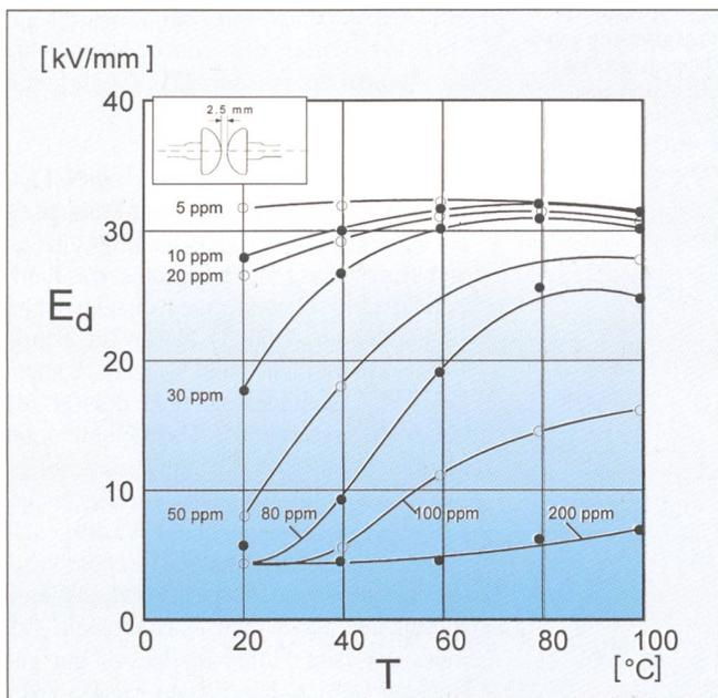
Bild 8 Die elektrische Durchschlagsspannung in Öl in Abhängigkeit von der Temperatur bei verschiedenen Feuchten [20]
