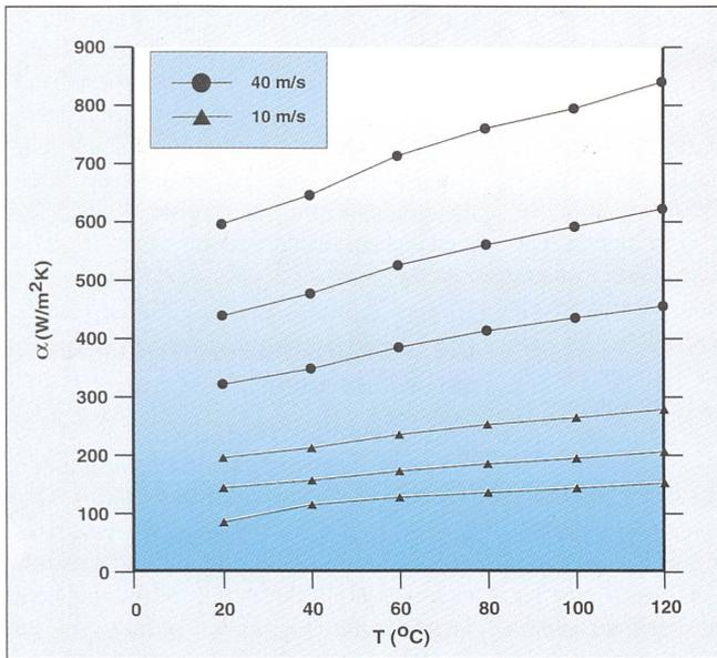
Bild 2 Wärmeübergang  $\alpha$  von SF<sub>6</sub>-Gas bei Strömungsgeschwindigkeiten von 10 und 40 m/s
