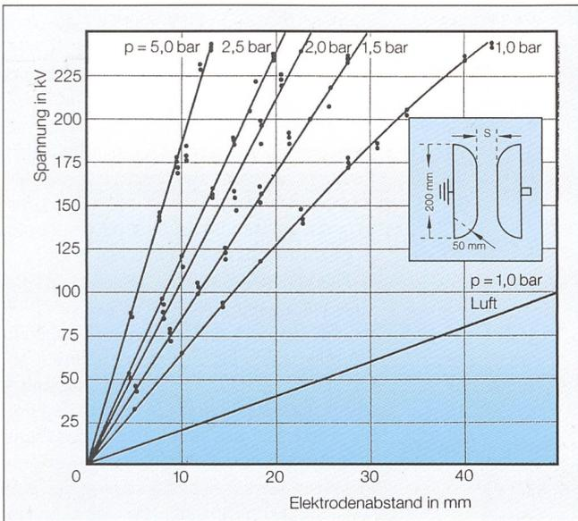
Bild 5 50-Hz-Durchschlagsspannung von SF<sub>6</sub> im homogenen Feld in Abhängigkeit vom Elektrodenabstand und bei verschiedenen Gasdrücken [12]
