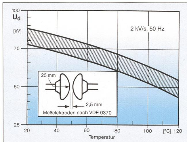
Bild 7 Durchschlagsspannung  $U_d$  von DT in Abhängigkeit von der Temperatur  $T$  [19]
