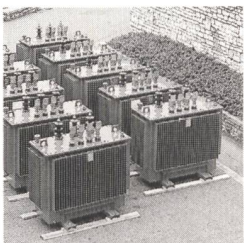
Dreiphasen-Verteiltrans- formatoren 1000 kVA; Typ A1000 16,5 ± 0,5/0,412 kV
