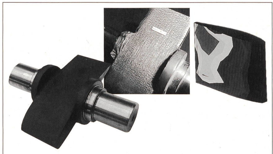
Bild 1 Neue und verschlissene Leitschaufel zu einer Francisturbine und das Bild der 3D-Abrasionsmesswerte. Mit zunehmendem Verschleiss nimmt der Wirkungsgrad der Maschine ab.
