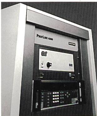
Das PC-gestützte EMV-Testsystem Proflin 4000 gemäss IEC 1000-4-6
