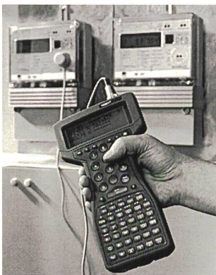
Elektronischer Zähler mit Ablesekopf und Ablesegerät Husky
