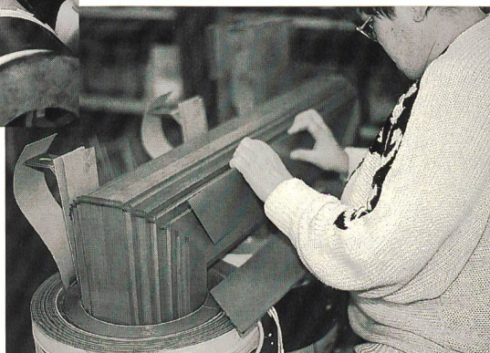
Bild 1 Transformatorenbau mit Maschine und Handarbeit
