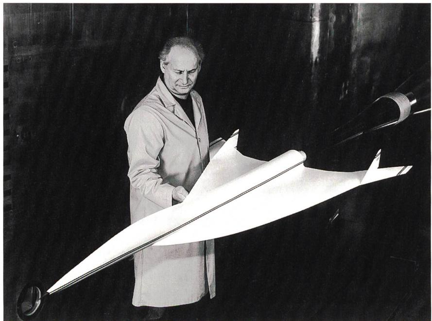
**Bild 1** Ein Techniker im NASA-Windkanal mit dem Modell eines Überschallflugzeuges, dessen Aerodynamik einem Test unterzogen werden soll. Die Resultate ergeben bei entsprechender Anpassung von Luftgeschwindigkeit und Lufttemperatur ein getreuliches Abbild des Flugverhaltens des späteren Flugzeuges. Dies setzt ein leistungsstarkes Synchronantriebssystem mit variabler Drehzahl voraus (Bild NASA).
