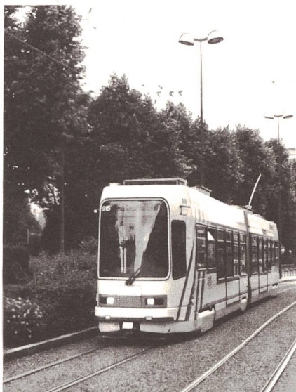
Figure 7 Tramways du réseau de la STAS à St-Etienne (F), alimentés par ligne de contact simple et perche
