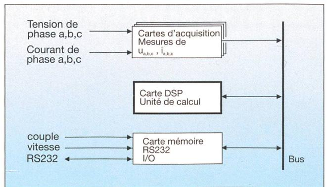
Un capteur de position permet de faire la mesure de la vitesse. Il s'agit d'un capteur optique sous forme d'un codeur absolu (code de Gray) délivrant la position. A partir du signal de position, moyennant une base de temps de référence interne à l'unité de calcul, il est possible de calculer la vitesse instantanée de la machine avec une très grande précision.
