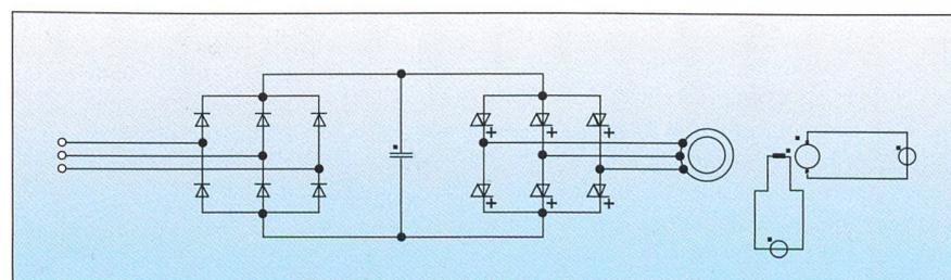
Fig. 12 Moteur asynchrone alimenté par convertisseur de fréquence
