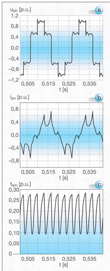
Fig. 13 Données mesurées de la machine asynchrone
