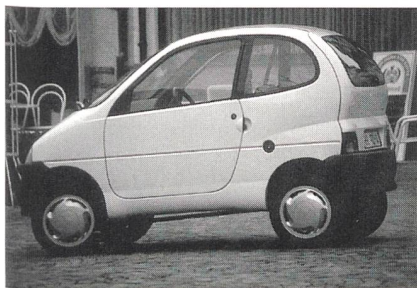
3 Der Ambra – von vielen als «Vorläufer» des Smart angesehen – ist mit einem Schweizer Asynchronantrieb ausgerüstet und wird mit verschiedenen Batterieversionen angeboten.
