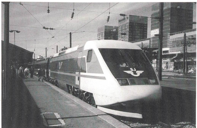
Schwedischer X2000 mit integrierter Neigtechnik.
