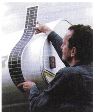
Neuartige, bedruckbare Abdeckfolie für Solarmodule (Foto Bayer)
