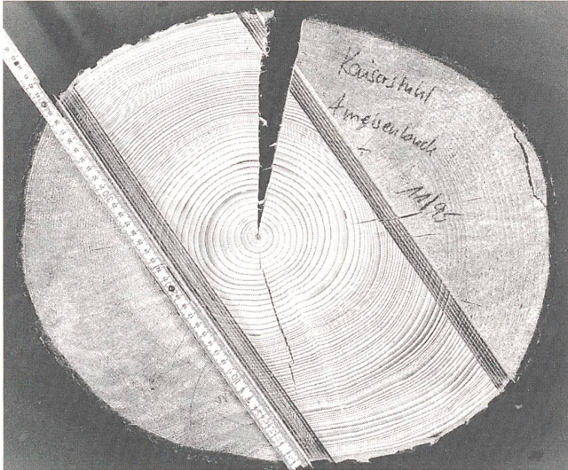
Lässt Bäume sprechen: Präzisionsfräsmaschinen machen die Mikrostruktur eines Baumstamms sichtbar. (Foto: Fraunhofer)
