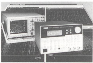
Waveform Manager speichert Daten vom Speicheroszilloskop.
