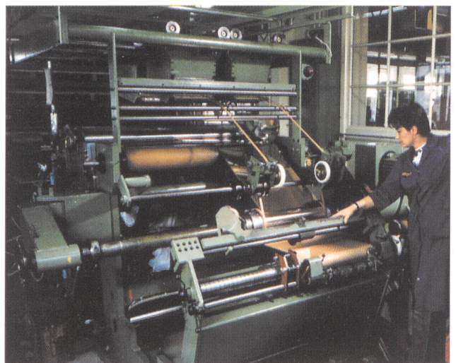
Fertigung von US-Bandwicklungen
