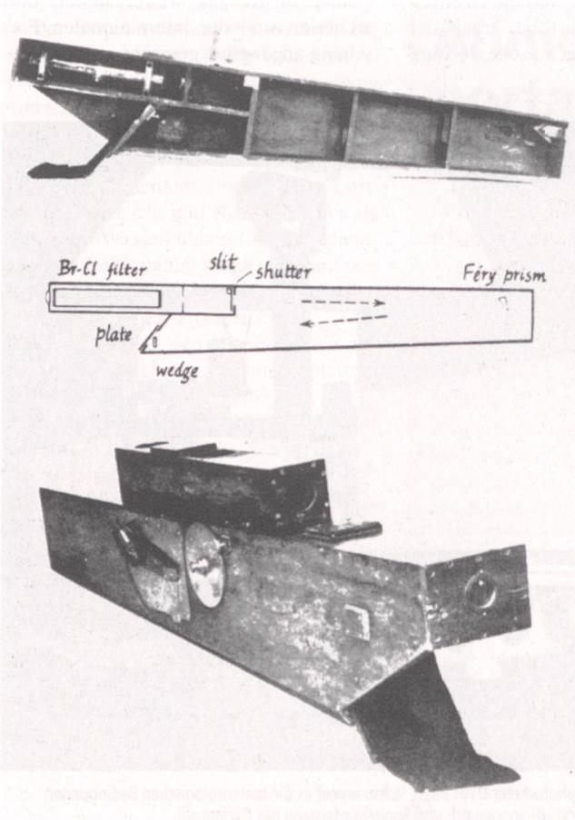
Bild 3 Das Dobson-Spektrophotometer Nr. 2 war 1926–1945 im Einsatz.
