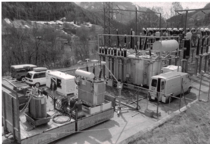
Bild 1 Versuchsaufbau für Teilentladungsmessungen
