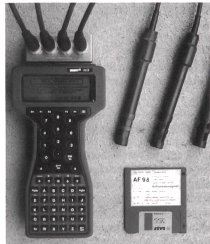
Bild 8 Das Serienprodukt AF98 ist ein 4-Sondengerät. Der Computer ist in einem wetterfesten, handlichen Gehäuse untergebracht. Die AF98-Elektronik mit den Steckbuchsen für die Messfühler ist direkt an das Gehäuse geflanscht, das vereinfacht die Handhabung im Feld nochmals erheblich.
