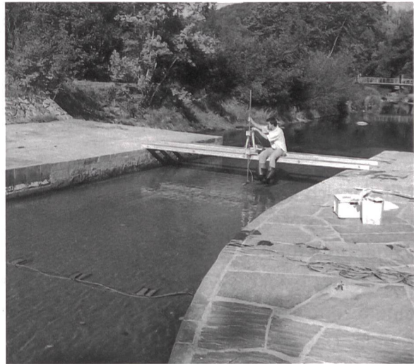
Bild 7 Parallelmessung an der Töss bei Altlandenberg. Im Vordergrund sind die Messfühler des Abflussmessgeräts AF97 zu erkennen, im Hintergrund wird gleichzeitig eine Abflussmessung mit Hilfe der Strömungsgeschwindigkeit durchgeführt (Messmethode: magnetisch-induktiv).
