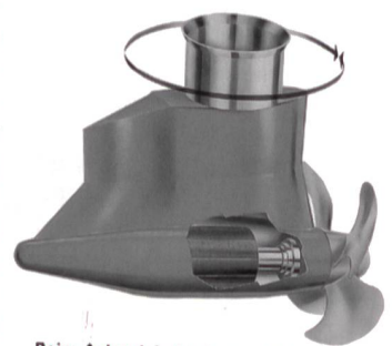
Beim Azipod-Antrieb von ABB befindet sich ein Drehstrommotor in einer unter dem Heck hängenden Gondel, die sich um 360° frei drehen lässt.
