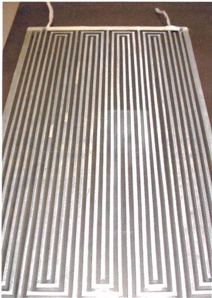
Bild 2 Thermisch gespritzte Alu-Heizleiter auf Glassubstrat als Heizplatte
