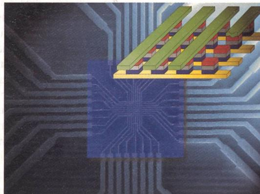
Die Magneto-elektronik, ein neuer Zweig der angewandten Physik, will dem Halbleiter Silizium mit ferromagnetischen Materialien Konkurrenz machen (siehe Beitrag auf Seite 9). Unser Titelbild zeigt in der Bildmitte die elektronenmikroskopische Aufnahme einer Matrix aus Tunnelbarrieren mit magnetischen Elektroden (rechts oben als Schema). Jede Barriere kann ein Bit Information speichern.
