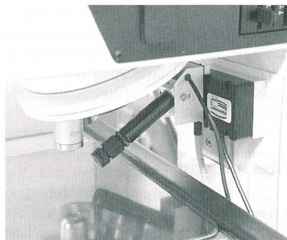
Bild 7 Integration des Lasers in das Mikroskop
