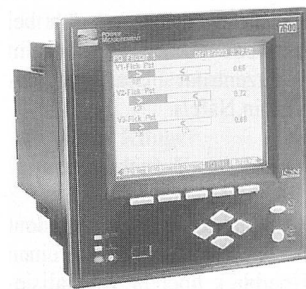
Dieses Drehstrom-Messgerät misst den Oberwellenanteil bis zur 127. Harmonischen.
