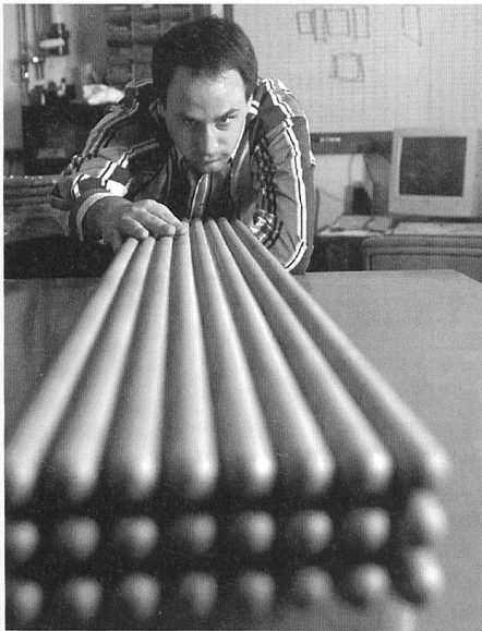
Das Herz eines SOFC-Kraftwerks: keramische Hohlrohre, die nur für Sauerstoff-Ionen durchlässig sind.
