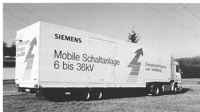
Komplett anschlussfertige, auf einem Sattelzugauflieger montierten, SF 6 -isolierte Schaltanlage.
