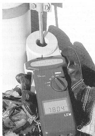
Erdschleifenmessgerät von LEM Elmes
