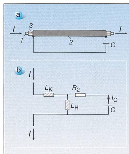
**Bild 1** Kabelader mit Kompensationskapazität im Mantelkreis
