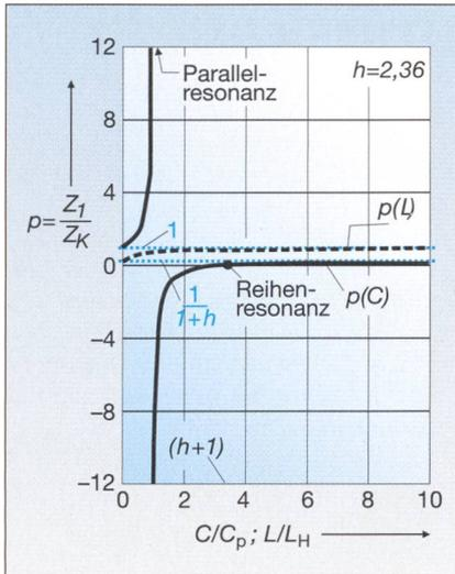
**Bild 2** Resultierende Längsimpedanz
