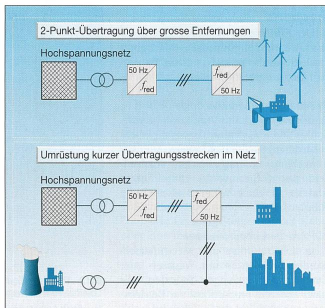
Bild 1 Schematische Darstellung zweier Einsatzmöglichkeiten einer frequenzreduzierten Energieübertragung
