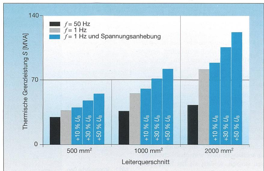
Bild 2 Thermische Grenzleistung von 30-kV-VPE-Mittelspannungskabeln in Abhängigkeit vom Leiterquerschnitt. Parameter: Betriebsfrequenz
