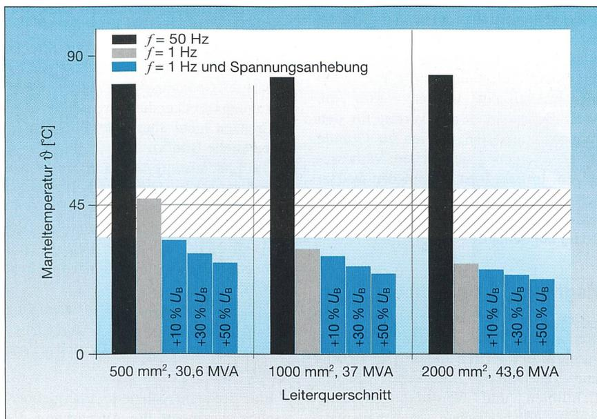
Bild 4 Manteltemperatur  $\vartheta$  bei Übertragung der thermischen 50-Hz-Grenzleistung von 30-kV-VPE-Mittelspannungskabel in Abhängigkeit vom Leiterquerschnitts
