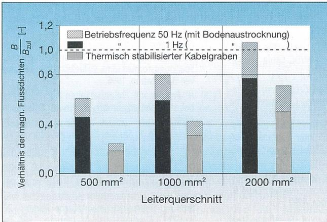
Bild 7 Verhältnis der magnetischen Flussdichte  $B$  zur zulässigen magnetischen Flussdichte  $B_{zul}$  (Expositionsbereich II, unkontrollierte Bereiche) von 30-kV-VPE-Mittelspannungskabeln bei Übertragung der 50-Hz-Grenzleistung
