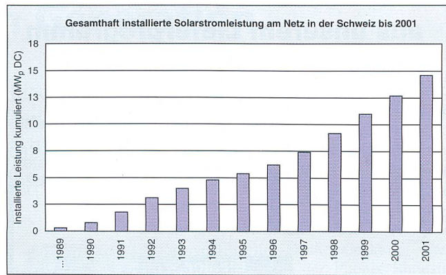
Bild 4 In der Schweiz waren Ende 2001 kumuliert rund 15 MW p Solarstromanlagenleistung am Netz. Dies entspricht einer Solarmodulfläche von rund 150 000 m 2 .
