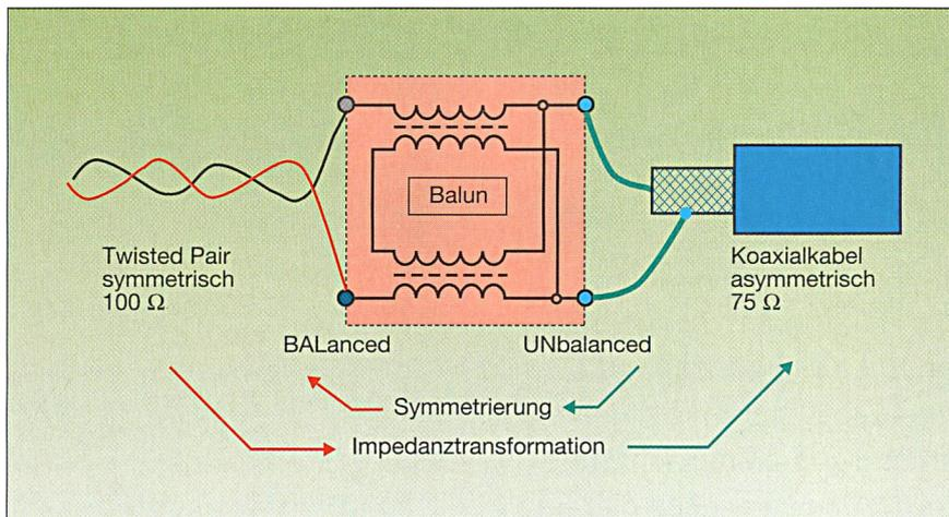
Bild 2 Schema für Balanced Unbalanced Signal Transformation (Balun)
