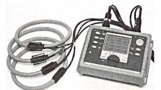
Analyst Q70 von LEM für die einphasige Prüfung der Netzqualität
