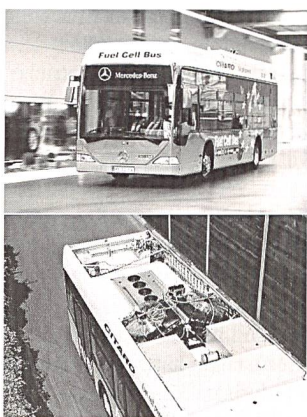
Der erste Linienbus Mercedes-Benz Citaro mit Brennstoffzellen-Antrieb fährt seit Mai 2003 in Madrid (Bild DaimlerChrysler).
