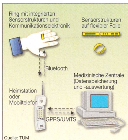
Bild 5 Schematische Darstellung des Ring-Projekts Die Daten werden mit Mikrosensorstrukturen aufgezeichnet, zur medizinischen Zentrale übertragen und dort gespeichert und ausgewertet.
