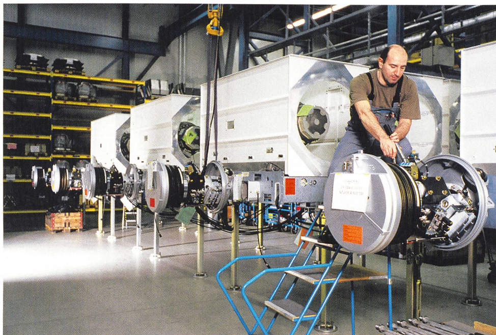
Die neuen Generatorschalter Typ HECS werden am ABB-Standort Zürich-Oerlikon produziert (Fotos ABB).
