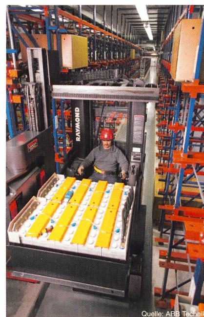
Bild 1 Batteriemodul mit 10 Zellen beim Transport
