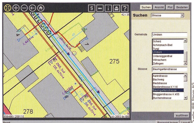
Bild 8 Ansicht von Werkleitungen auf PC
