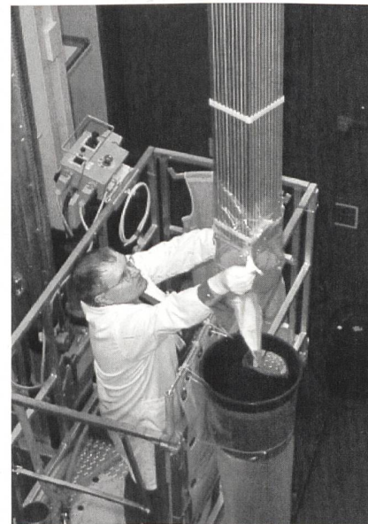
Reaktorphysikalische Experimente am PROTEUS. Deborierungs-Vorgang am Druckwasser-Reaktor-Mockup. Mit den Experimenten wurde der Einfluss verschiedener Moderationsverhältnisse auf die abbrandbedingte Reaktivitätsabnahme im nuklearen Brennstoff untersucht.
