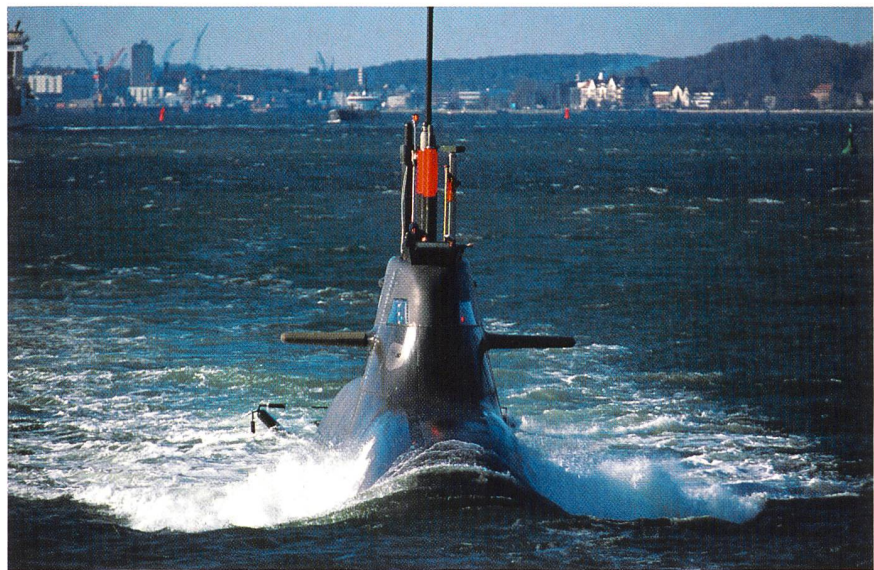
Erstes serienreifes U-Boot («U 31», Klasse 212) mit aussenluftunabhängigem Brennstoffzellen-Antrieb (Bild HDW).
