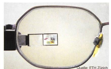
Bild 7 Microdisplay (von Microoptical Corp.)
