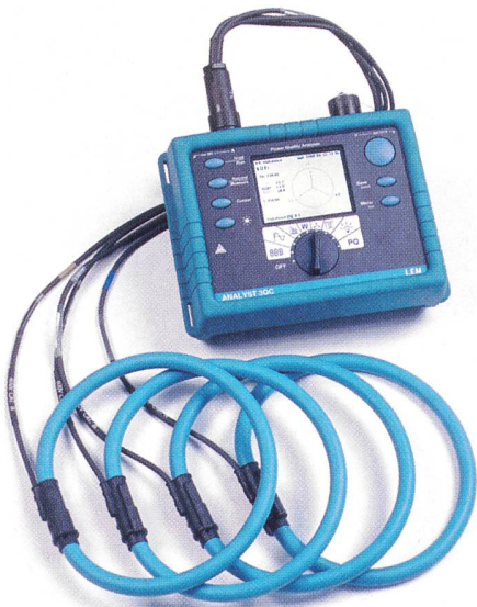
Netzanalysator Analyst 3Q von LEM für Qualitätsmessungen nach EN50160
