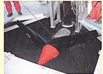
Axiale 16-kW-Versuchsturbinen (Bild Verdant Power).
