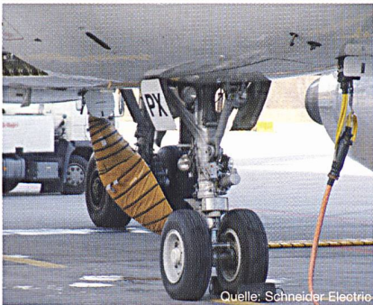
Bild 3 Das Flugzeug wird am Boden mit Strom und Frischluft versorgt
