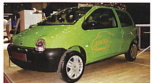
Die Batterie von Renaults Twingo Quickshift verhilft dem Fahrzeug zu einer Reichweite von 130 km und kann in einer Stunde zu 80% geladen werden.
